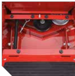
Verwijderbare vloerplaat biedt handige toegang tot de bovenkant van het dek voor reiniging en onderhoud.
