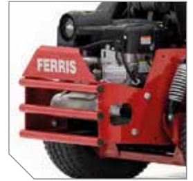
Zware bumper beschermt de motor en geeft ook makkelijke toegang voor onderhoud.
