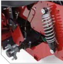
Ophanging met onafhankelijke schokdempers met hulpveer achteraan (zie foto) en scharnierende vooras met schokdempers.
