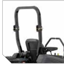
180° inklapbare ROPS-veiligheidsbeugel met rolgordel.
